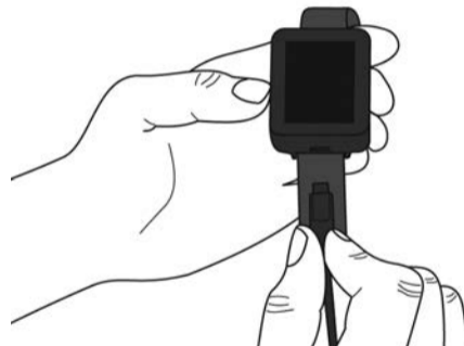
Рисунок 3 – Подключение зарядного устройства к аппарату
